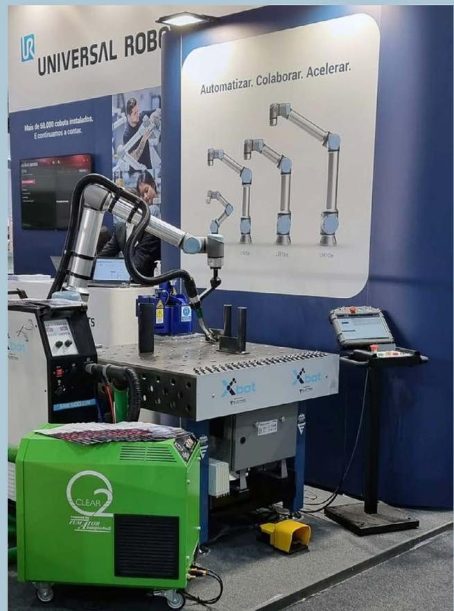
Xbot, uma solução de soldadura robotizada desenvolvida pelo parceiro da UR Electrex.
