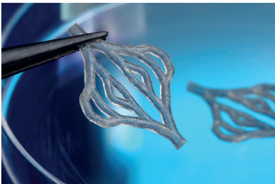
Uma estrutura ramificada, elástica e vascularizada produzida através da polimerização de um único fotão. Esta estrutura é um implante vascular biorreabsorvível que se decompõe progressivamente num período de 24 meses. Foto: Fraunhofer ILT, Aachen.
