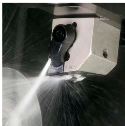
Figura 5. Ferramentas de torneamento com pastilhas ISO intercambiáveis, com fixação de flanges superior.
