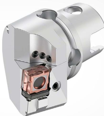
Tipos de porta-ferramentas FIX8 com tecnologia de refrigeração 3D de precisão. Fornece líquido refrigerante suficiente e precisamente onde ele é necessário.
